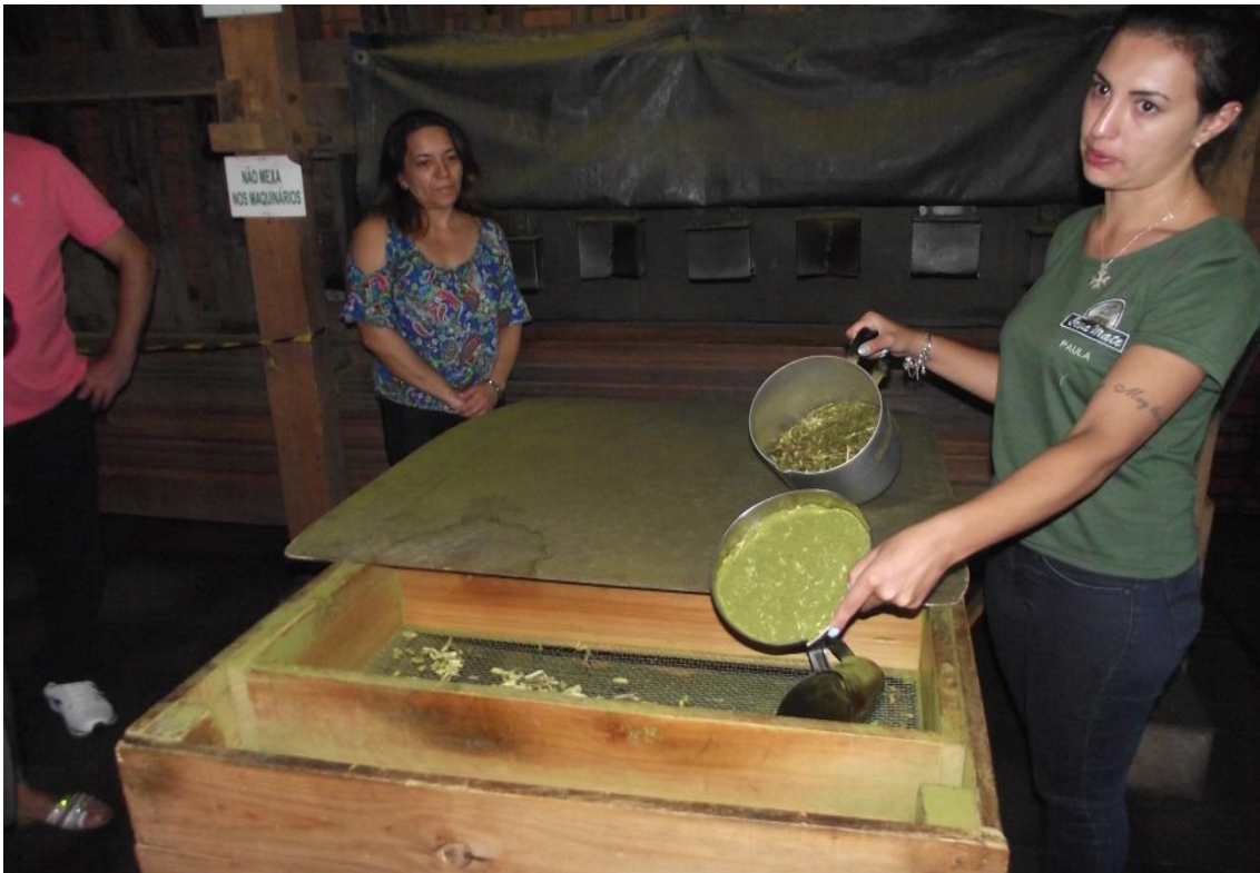
Processo de separação da erva-mate (peneira)
